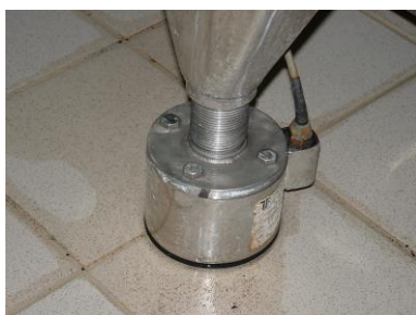
vážiaci systém ALYA pre zásobníkové technológie prevádzky potravinárskej výroby
